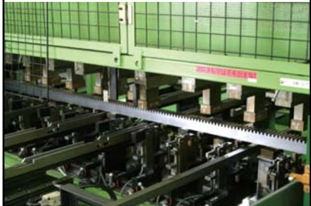
切齒後的齒條會彎曲變形，必須利用油壓整形機加以整形校直。
