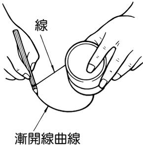
取一條細線與一圓筒，將圓筒置於一張白紙上。今將細線一端固定於圓筒上，另一端綁上一枝鉛筆，並將細線纏繞在圓筒上。
