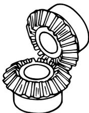
在直交的兩軸間，使用一對齒數相同的傘形齒輪，做轉速 1:1 的傳動，此齒輪特稱為等比傘形齒輪 (Miter gears)。
